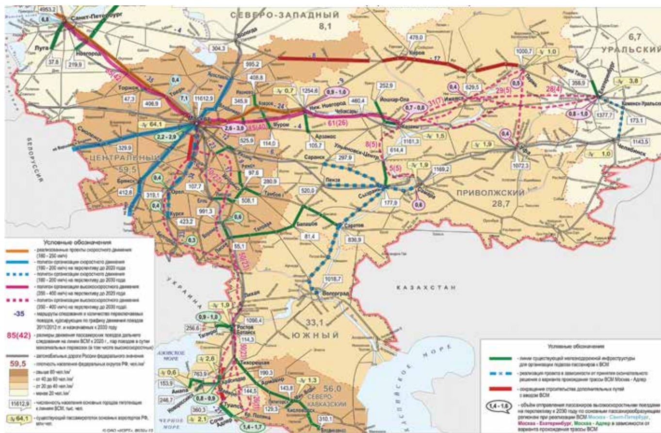
Рис. 9. Схема организации движения пассажирских поездов на сети ОАО «РЖД» при реализации проектов ВСМ Москва – Санкт-Петербург, Москва – Екатеринбург (с ответвлением Казань – Самара), Москва – Адлер с учетом организации подвоза пассажиров к ВСМ по существующей железнодорожной инфраструктуре на перспективу до 2030 г.
